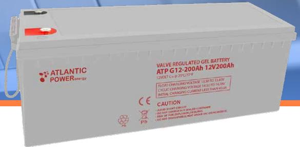
La Serie ATP-G está fabricada siguiendo las más altas exigencias en el sector. Ideal para aplicaciones de ciclo profundo y energías renovables. Las baterías utilizan gel de sílice coloidal o espumado para inmovilizar el electrolito, lo que mejora aún más la estabilidad cíclica. Disponible en tipos de terminal superior y frontal.
